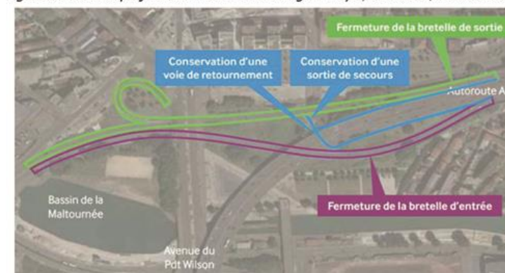
Figure 3 : Travaux projetés au niveau de l'échangeur de Porte de Paris, sur l'A1 (source : dossier)
